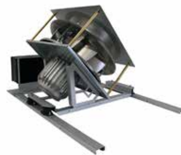
Motorsektionerne er monteret i svingningsdæmpere, hvilket betyder mindre støj og vibrationer i kanalerne, og man behøver ikke montere flexforbindelser mellem aggregat og kanalsystem. Motorsektionerne er udtrækkelige for nemmere service. Motorerne er type EC med meget høj virkningsgrad, der lever op til EcoDesign direktivets krav.
